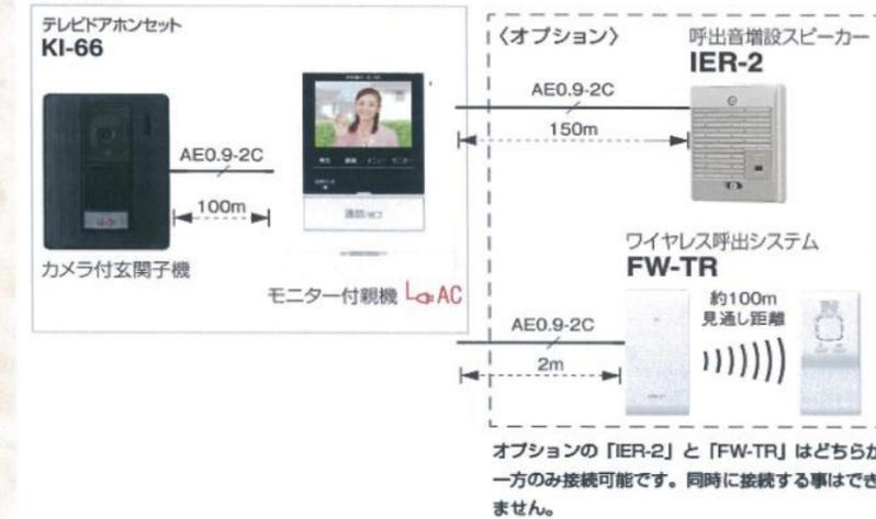
カメラ付玄関子機1台、モニター付親機1台、モニター付中継子機を設置した例
